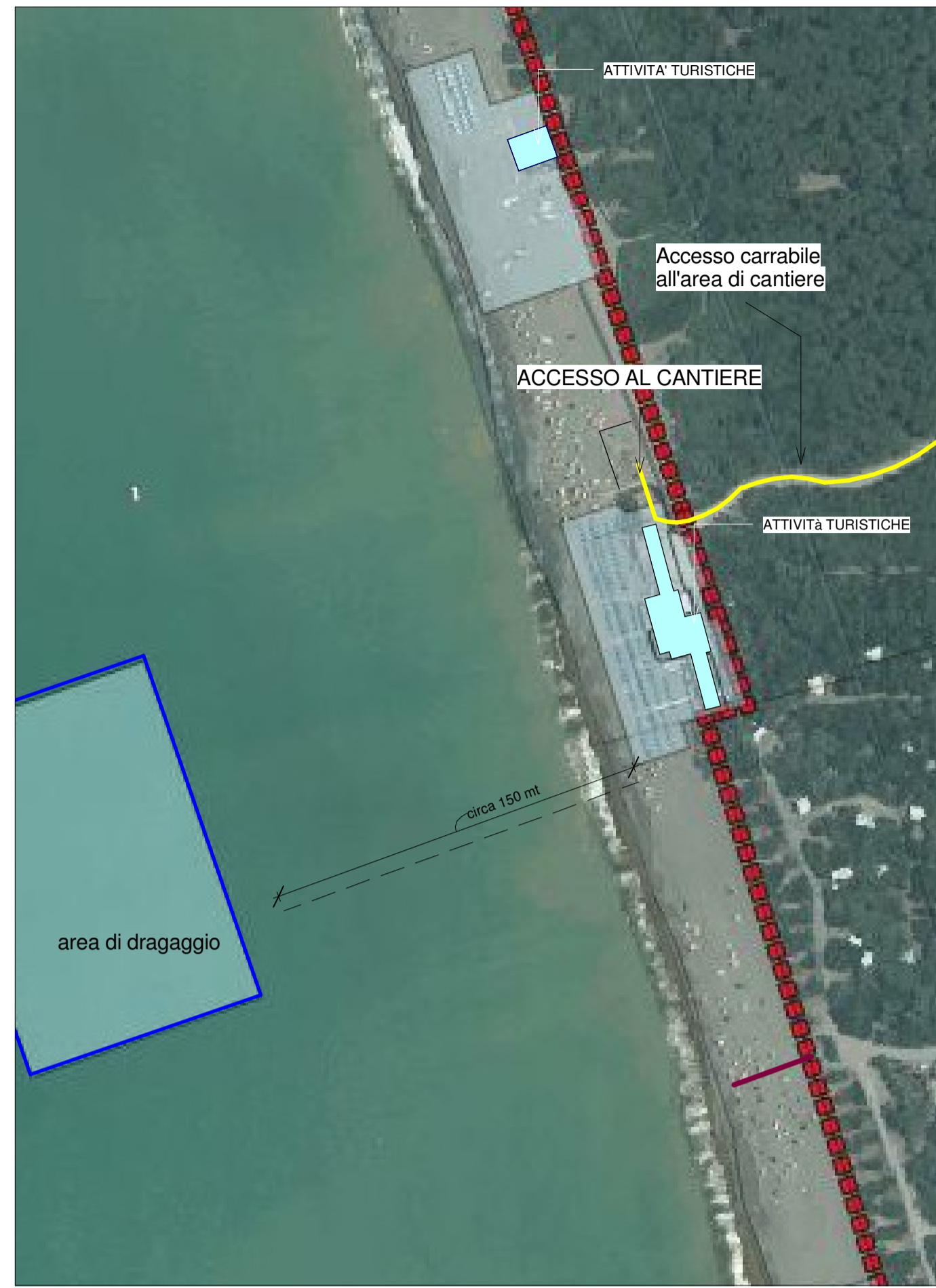
ACCESSO CARRABILE AL CANTIERE Scala 1:2.000
