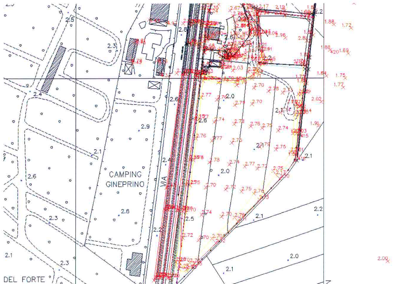
Figura 2: Sovrapposizione delle quote di rilievo (in rosso) con quelle della cartografia CTR impiegata nello studio idrologico idraulico allegato al RU (in nero)
